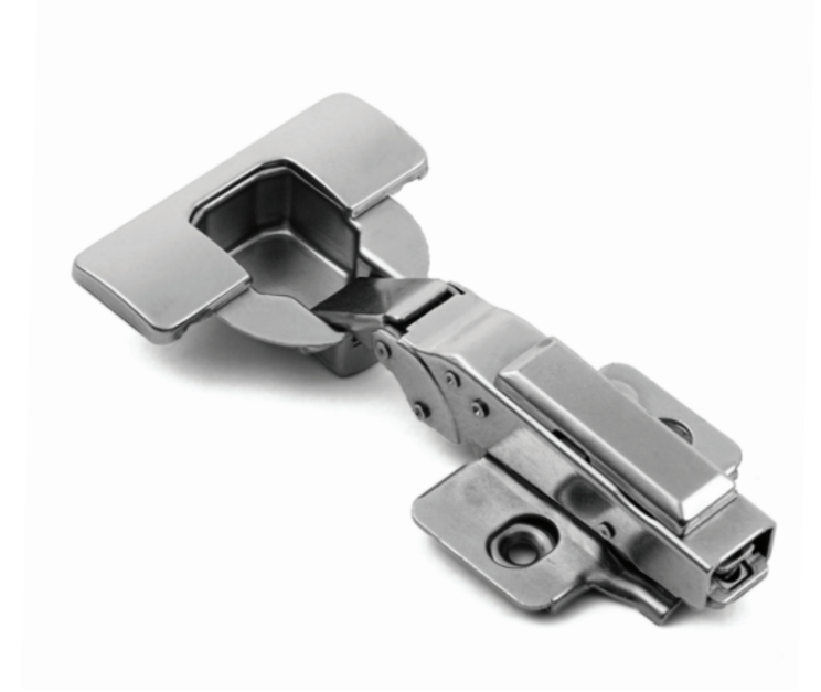
4033 | 95° / آرام بند / فنردار / کلیپس دار / پایه سه بعدی / درب و بدنه 18~30 / کاپ 40
