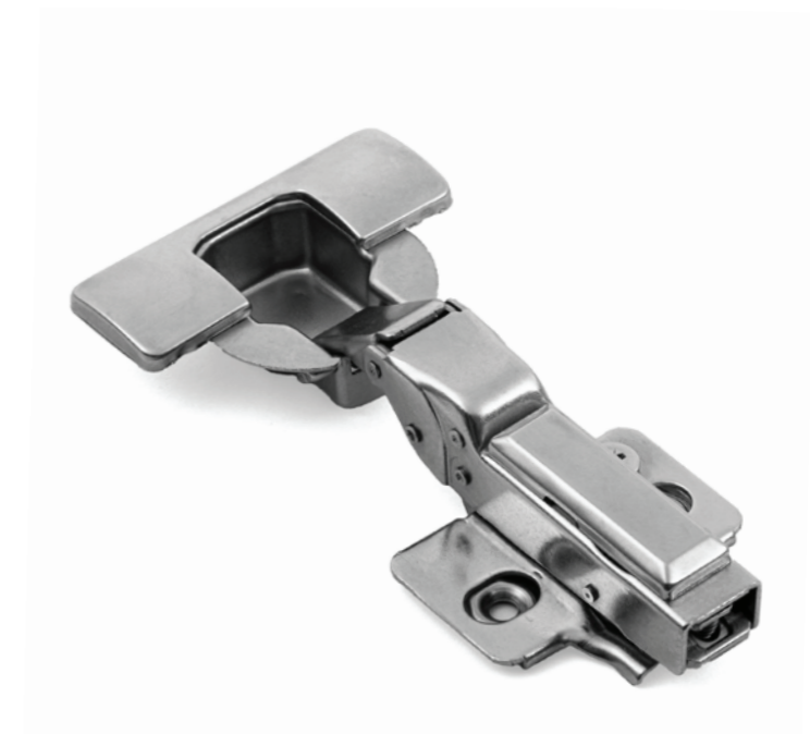
4034 | 95° / آرام بند / فنردار / کلیپس دار / پایه سه بعدی / درب و بدنه 18~30 / کاپ 40 / بدنه مشترک
